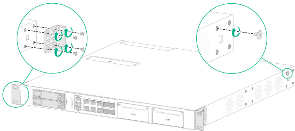
图2-3 安装前挂耳和承重螺钉
